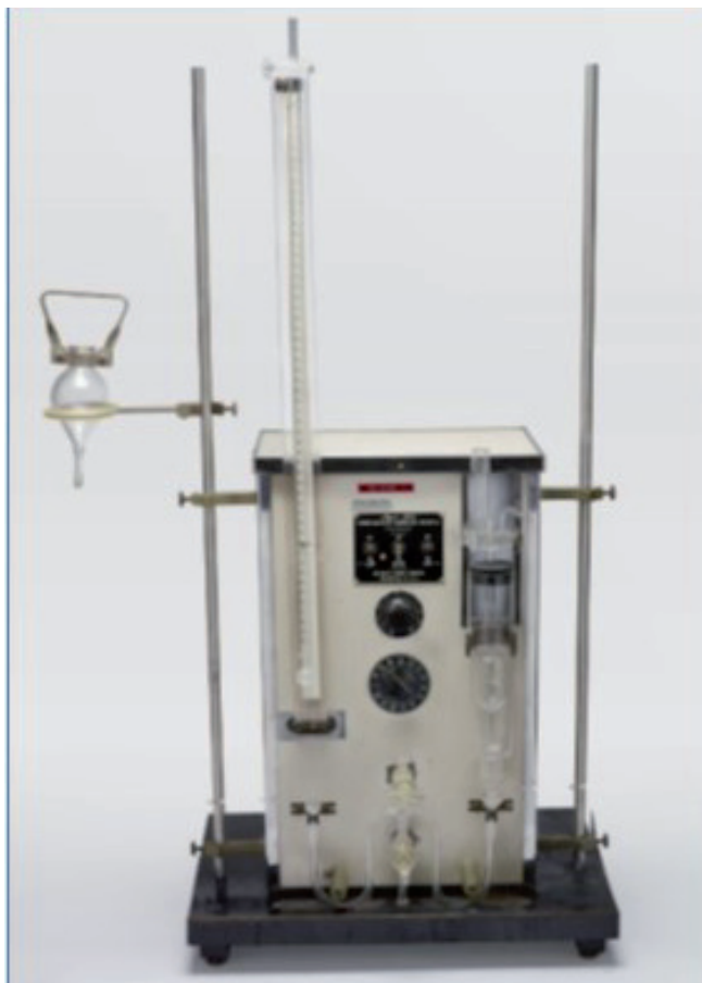
Un vell aparell de manometria de mercuri de Van Slyke
